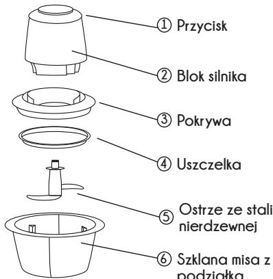
Założyć uszczelkę na pokrywie pośredniej, powierzchniami stykowymi A i B do siebie.
