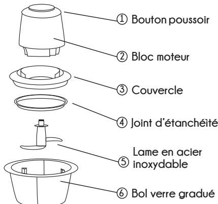
Placez le joint d'étanchéité sur le couvercle intermédiaire dans le sens des surfaces de contact A et B.
