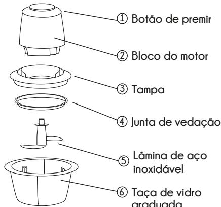
Coloque a junta de vedação na tampa intermédia, no sentido das superfícies de contacto A e B.
