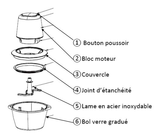
Placez le joint d'étanchéité sur le couvercle intermédiaire dans le sens des surfaces de contact A et B.
