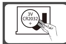
Pile lithium 1 x 3 V (CR2032). Veuillez retirer le film isolant présent sur le contact de la pile avant utilisation.
