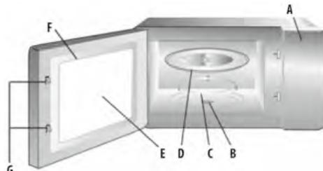
Indien de oven wordt geopend terwijl de oven in werking is, wordt de stroomspanning verbroken.
