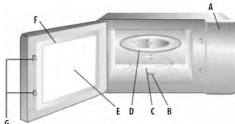
Si la porte est ouverte en cours de fonctionnement du four, le four est mis hors tension.
